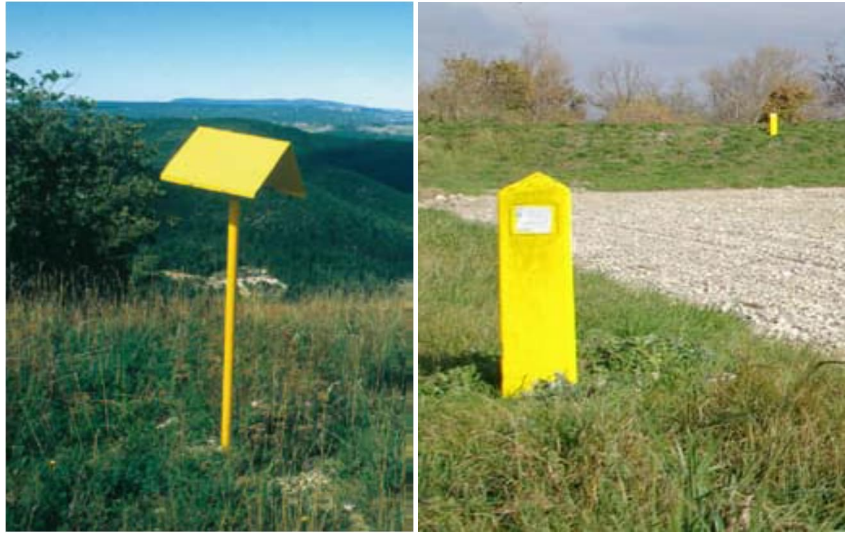
Figure n° 13 : Balise (à gauche) et borne (à droite) de signalisation
